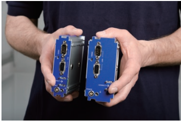
スライドレールに沿ってモジュールを結合
