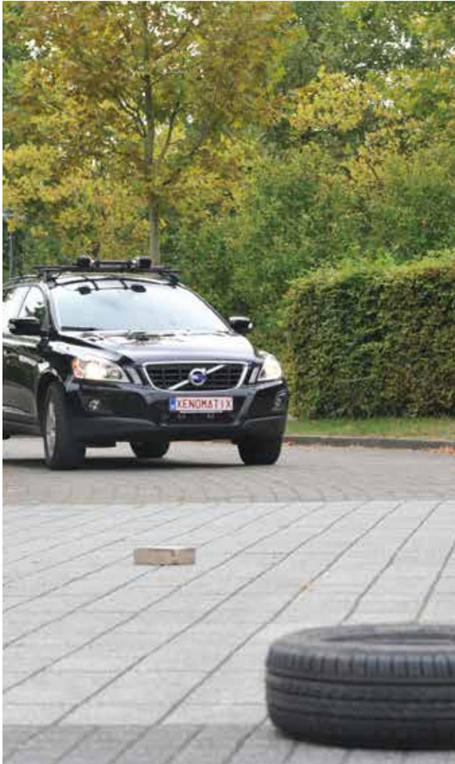
XenoTrack-RTは、LiDAR(ライダー: Light Detection and Ranging “光による検知と測距”)を用いて路面形状を計測するシステムです。センサを車両のルーフなどに取り付け、路面の凹凸をLiDARを用いて計測します。このLiDARは、True-Solid-state方式(可動部を全く搭載しない方式で2mm以下の超高精度を実現)を採用しており、多点を同時に計測することが可能で、高速走行時でも計測することができます。
