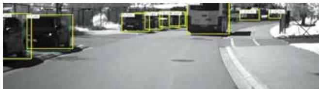
車検出のためのAIベースの画像処理(LIDARによる測距とのセンサーフュージョン)
