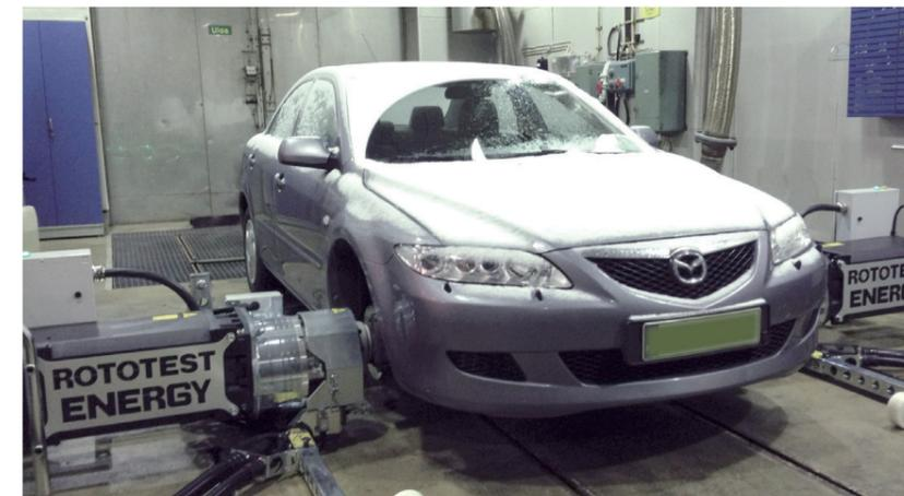
動作温度範囲-35°C~+40°Cに上げたモデルとなります。スペースなどの要件を満たしていれば、すでにお使い頂いている環境室内でご利用いただくこともできます。ステアリングの操舵を含めた寒冷地での走行再現試験にお使いいただけます。
