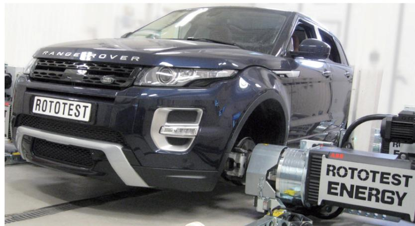
ROTOTEST® Energy™ 500-250 4WDは各軸それぞれ500kW, 250kWのダイナモで構成されます。試験車両に合わせて2WDと4WDを切り替えて使うこともできます。再現性も高くベンチマーク試験にも最適です。またお客様のご要望に応じた出力に対するモデルもいくつかご用意しております。
