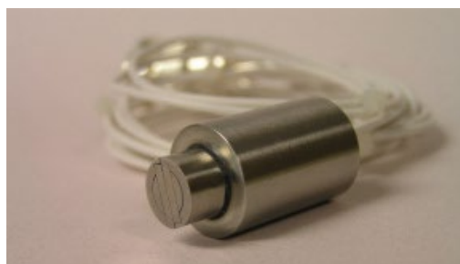
測定物からグラウンドをとる必要がない、 2つの電極がある特注プローブの例
