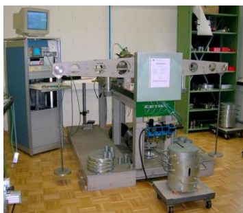
Magtrol SA社のトルク校正設備
