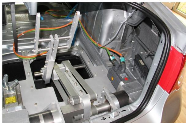
2DLIDテスターはボンネット、トランク、スライドドアの開閉テストベンチです。このシステムで曲線カーブ軌道のプログラムとティーチングが可能です。これにより全てのタイプのトランクに適用が可能になります。
