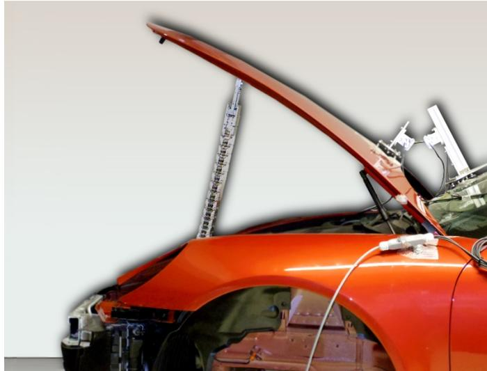
Hydraではボンネット内部の作動レバーを稼働してボンネットを開きます。その際、エンジンルームでのロック機構が解除がされ、ボンネットを最大ポイントまで開きます。その時、ボンネットカバーは自動的にストップ地点まで開きます。次に最高到達点で外側のシートから圧力が加わって、ボンネットが閉まります。その際、ボンネットカバーはロック地点まで自動的に下降します。また、空気圧シリンダーで車内のロック解除が動作します。
