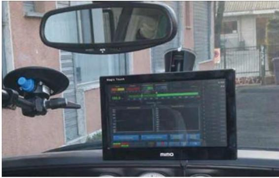
運転席でタッチパネルでの試験設定
