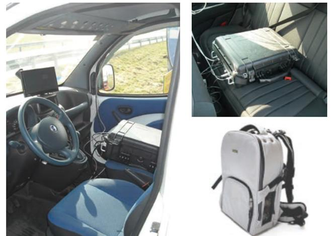
上図：典型的な DualCar の設置例、助手席、後部座席と対歩行者衝突軽減システム試験用バックパック（重量：約 7kg）。
