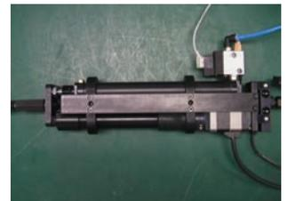
ギアロボット モータおよびエアのダブルシリンダ (踏力 400N または 800N モデルあり)
