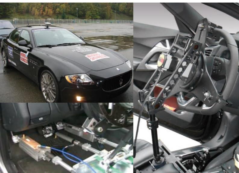
GPS 制御実車走行試験ロボット
