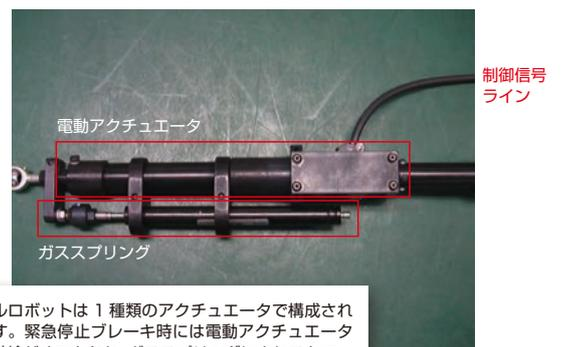
アクセルロボットは 1 種類のアクチュエータで構成されています。緊急停止ブレーキ時には電動アクチュエータの電源供給がオフとなり、ガススプリングによりストロークが引き戻されます。
