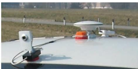
車の屋根に取り付けた GPS, IMU, Wi-Fi, カメラ
