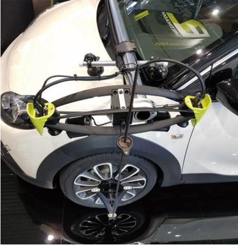
強い振動が発生する試験ではボンネットを外しボディと一体になるように固定します
