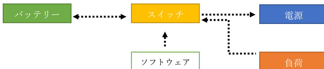
図1: バッテリー充電／放電試験の一般的なテスト構成
