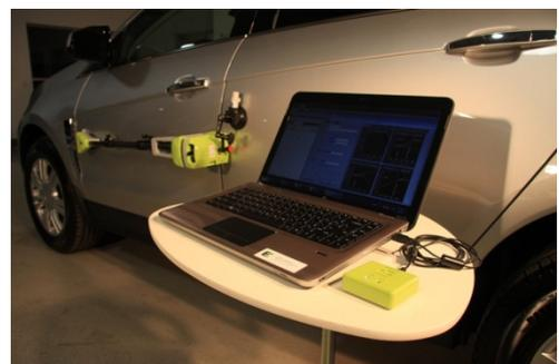
ドア開閉エネルギー計測システム「EZ Slam2」は、ドア評価に必要なパラメータを全て同期して計測し、かつ計測パラメータを全てエネルギー値に変換することができる世界で初めての計測システムです。ドアの構成パーツごとの
