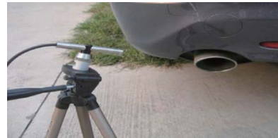
自動車排気音の測定
