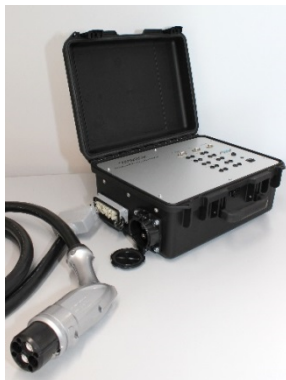
<CHAdeMO アナライザ／シミュレータ>
