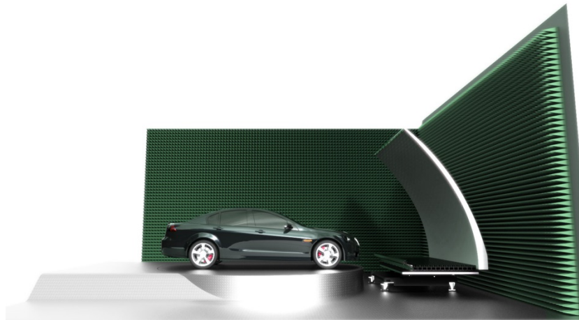
試験セットアップイメージ(車両の前に設置されているのが「自動車 CATR ソリューション」)
