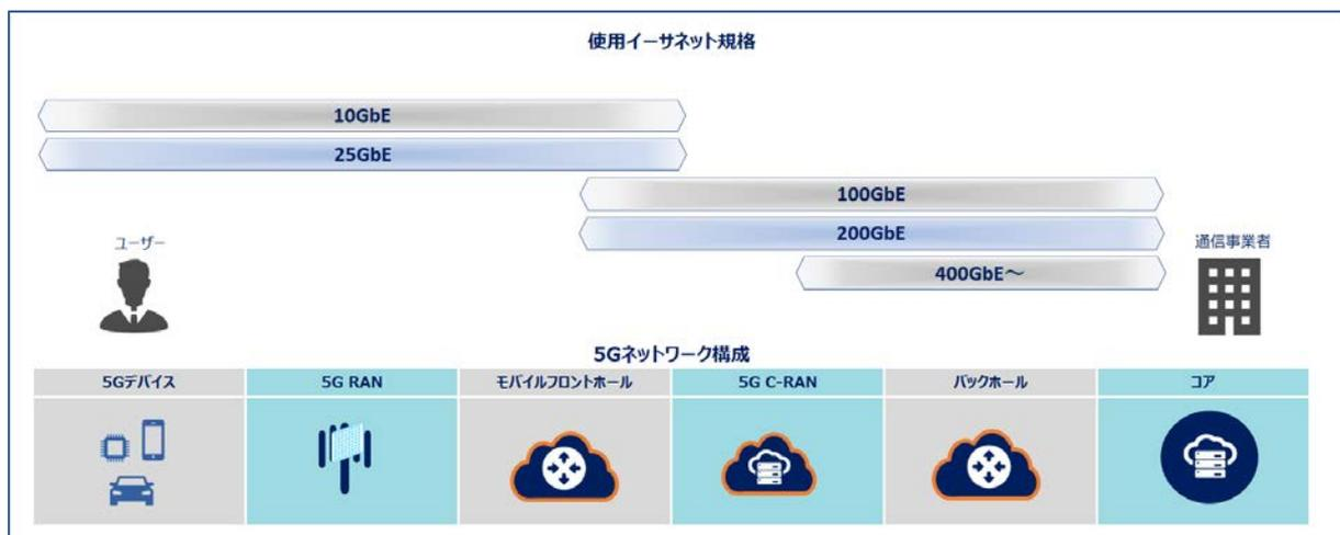
2020年に国内での本格的なサービス開始が予定されている5Gネットワークでは、ユーザー側(モバイルフロントホール)は25GbE規格での運用が予定されています。そのため、障害が起こった場合の解析用のツールとして25GbE規格に対応し、かつ障害箇所が複数にわたる場合に備え持ち運びのできるパケットキャプチャ装置が求められていました。
