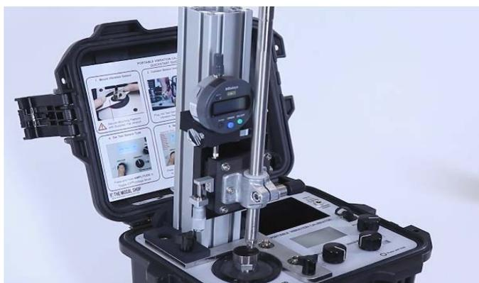
軸振動センサ校正器「9110D/9100-PPASH」イメージ
