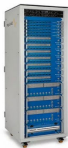
モジュール式充放電測定システム 「BCS-9XX シリーズ」 (Bio-Logic 社製)
