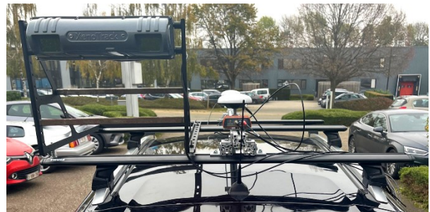
レーザー照射イメージ(図左)と実際に車両のルーフに取り付けた様子(図右)
