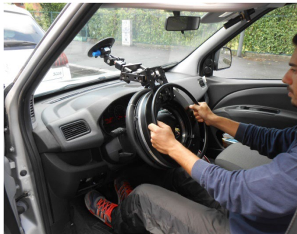
高精度ステアリングロボット「STA-ROBO System」実装イメージ
