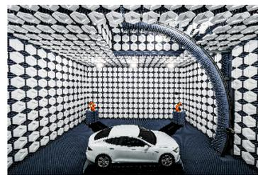
コネクテッドカー向け無線通信性能計測システム
