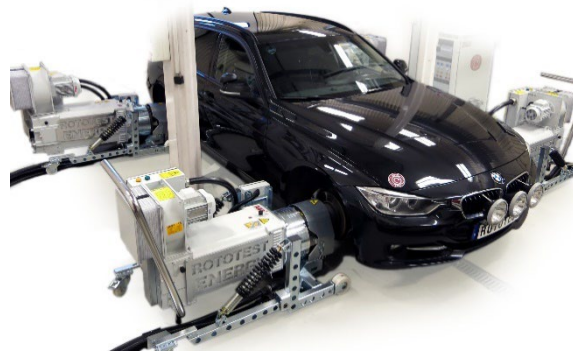
ハブ結合式シャシダイナモメータシステム「ROTOTEST® Energy™」
