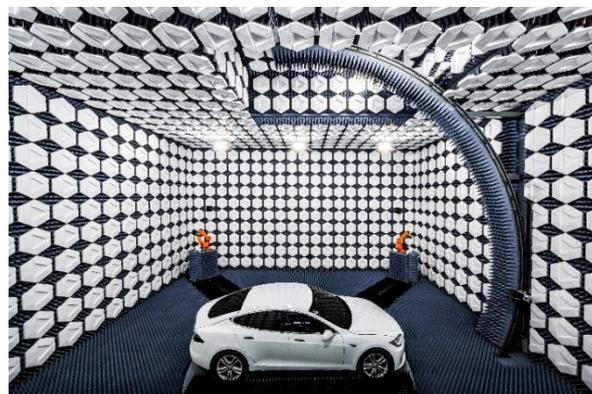
「コネクテッドカー向け無線通信性能計測システム」イメージ図
