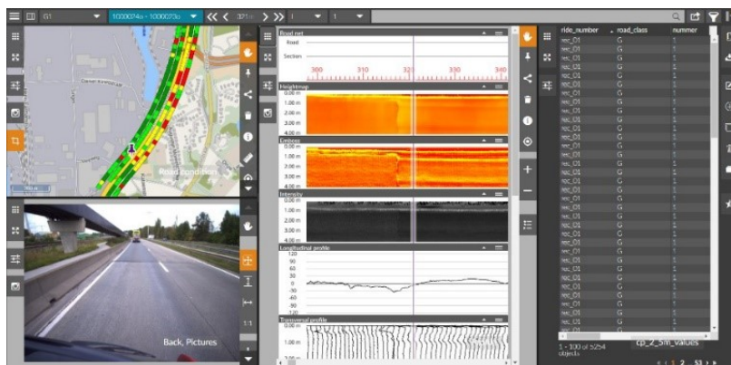
「XenoTrack」で測定したデータの解析画面例 (路面性状解析クラウドサービス「RoadViewer」の画面)
